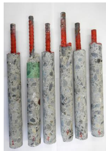
写真-4 採取したコア試験体
