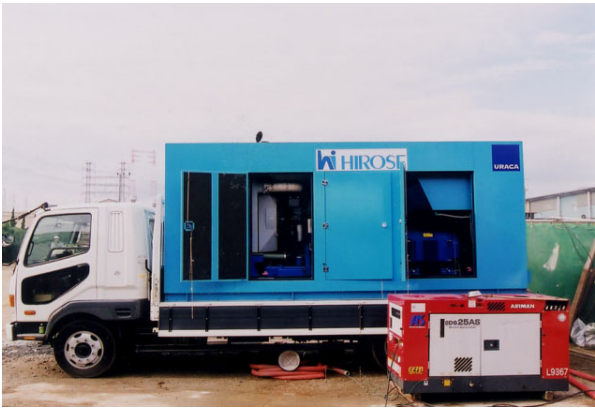
写真4 高圧ブランジャーポンプ搭載はつりユニット# (最大圧力 100MPa、最大水量#170 ℓ/分) #
