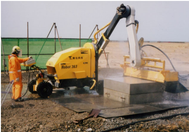
写真3 揺動式ロボットタイプ (重量 2.4tf) (ノズルはブームの先端に取付け)
