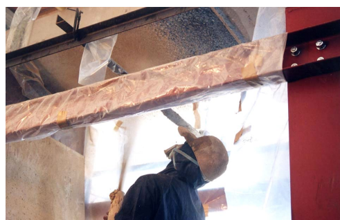
写真7 振動下での吹付け試験 (たわみ全振幅 0.5mm, 振動数 5Hz, 24 時間加振)
