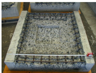
写真4 はつり後の試験体
